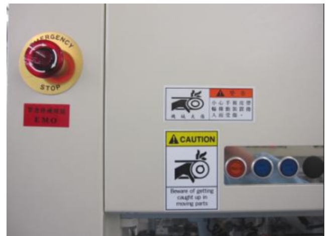
設備機台中英文危害標示
