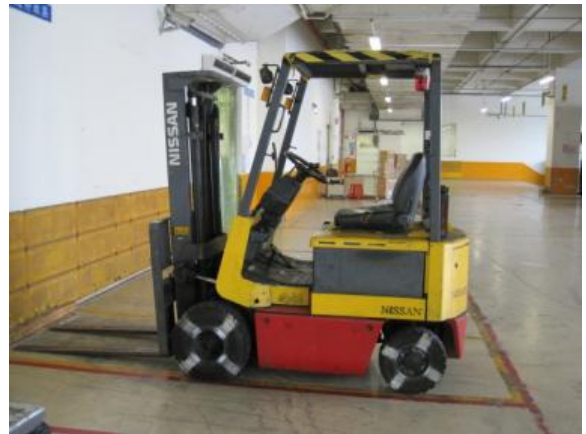
堆高機車輪標示十字線，以為超速監控依據
