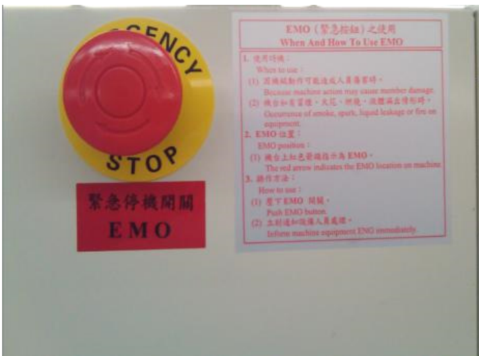
設備機台緊急停止裝置中英文標示
